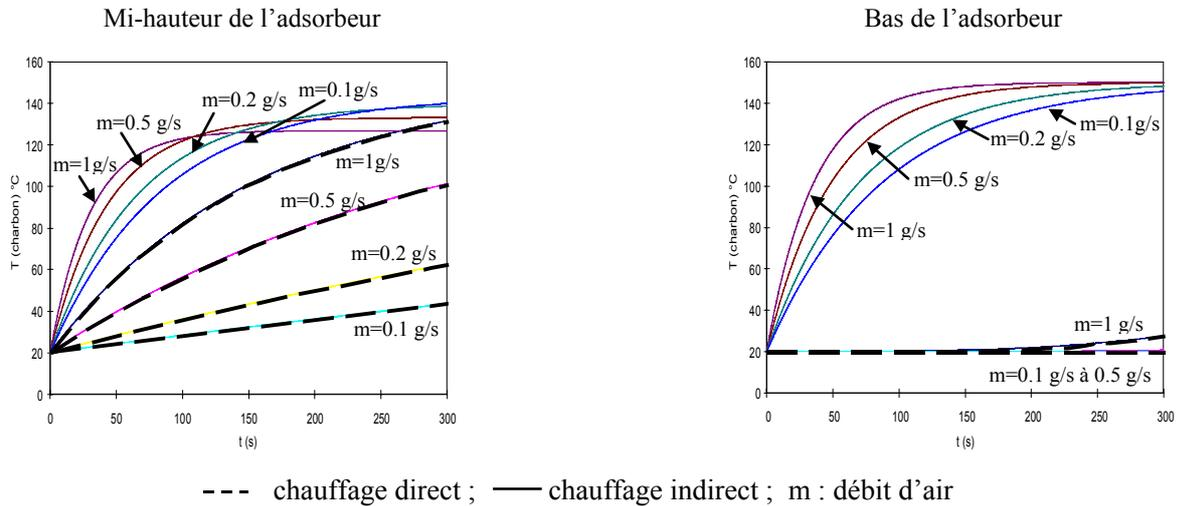
Fig. 1- Comparaison chauffage direct /chauffage indirect
