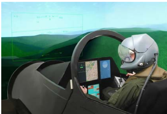
Utilisation de la plate-forme Eloquence pour la gestion des sorties multimodales dans le simulateur d'un avion de combat de type Rafale de Thalès-Avionics
