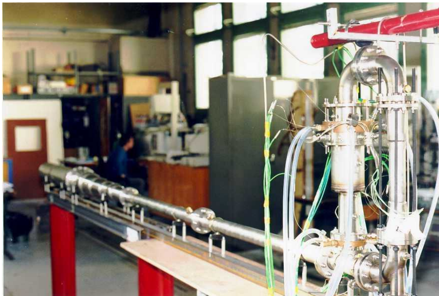
FIG. 4 – Vue du générateur d'ondes acoustiques de type Swift – Backhaus construit et mis au point au Laboratoire. On distingue la partie linéaire couplée au réservoir en bout et qui assure une résonance de type Helmholtz et la boucle où l'interaction chaleur son se fait dans un transfert de chaleur isotherme au sein du régénérateur.
