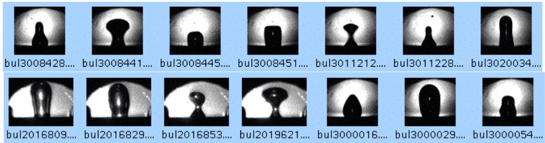
Fig. 1. Différentes formes de bulles observées au cours de la mise au point du banc d'essais.
