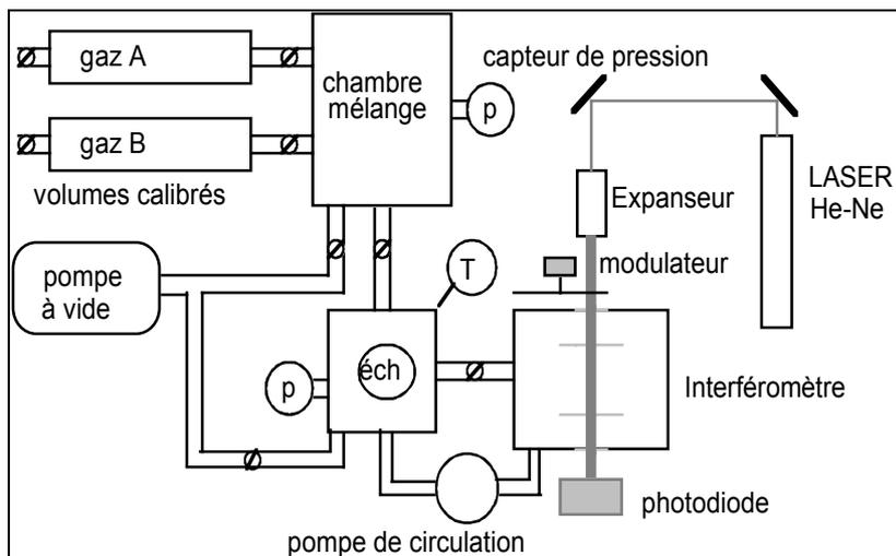
Figure 1 : Schéma de principe de l'appareil
