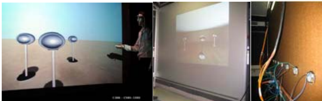
Système de réalité virtuelle audio par Wave Field Synthesis utilisant des haut-parleurs sur panneaux plats (LaMAP, Large Multi-Actuator Panels)
