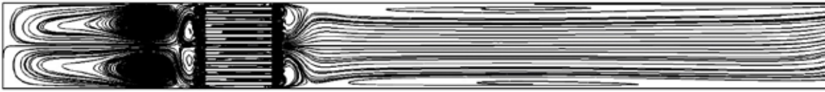
Figure 8 : Topologie de l'écoulement de moyen dans un générateur d'onde stationnaire
